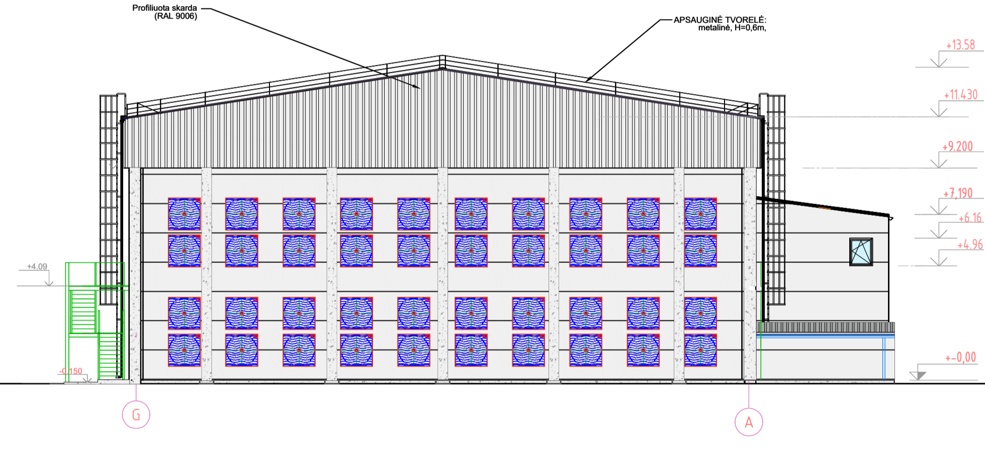
PAUKŠTIDŽIŲ FASADAS TARP AŠIŲ G-A M 1:200
