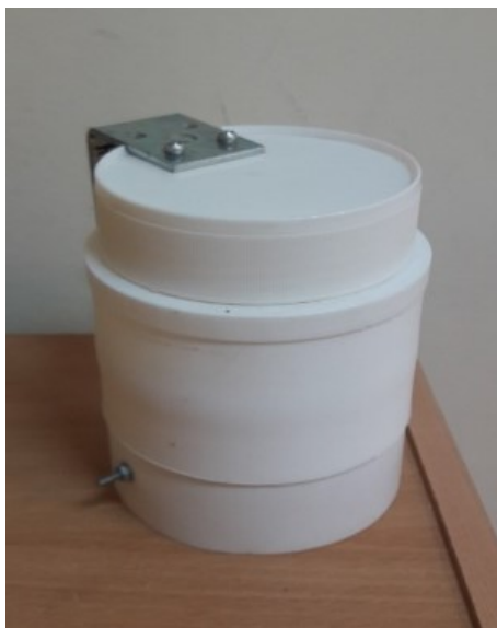
1.2 pav. Pasyviųjų sorbentų (kaupiklių) tvirtinimo įrenginys
