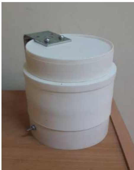
1.2 pav. Pasyviųjų sorbentų (kaupiklių) tvirtinimo įrenginys
