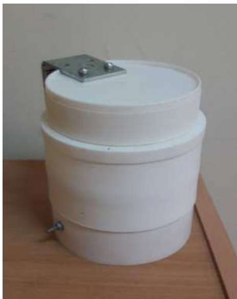
1.2 pav. Pasyviųjų sorbentų (kaupiklių) tvirtinimo įrenginys
