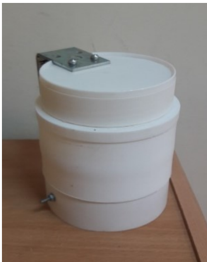
1.2 pav. Pasyviųjų sorbentų (kaupiklių) tvirtinimo įrenginys
