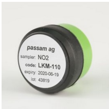
1.4 pav. Azoto dioksido pasyvusis sorbentas (kaupiklis)
