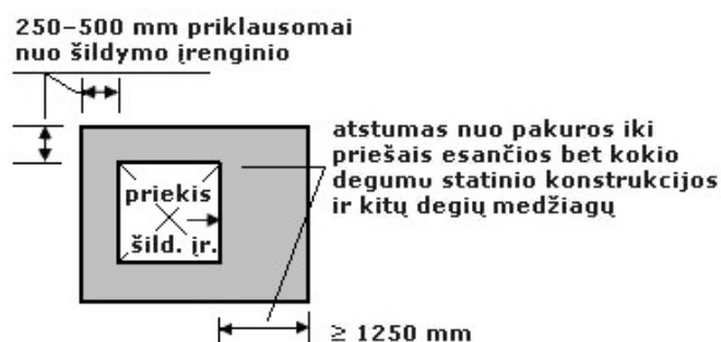
Pav. 3. Atstumo tarp šildymo įrenginio ir statinio konstrukcijos ir kitų degių medžiagų nustatymo principas
