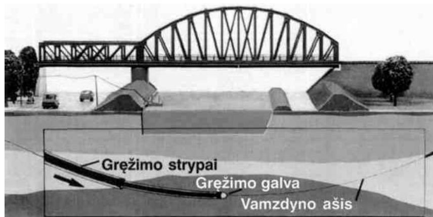
3 pav. I etapas. Pradinio tunelio gręžimo procesas.
